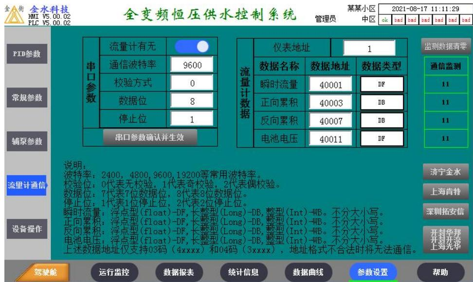
简介：该页面用于连接各种类型的流量计，市面上支持 ModbusRTU 协议的流量计几乎都可以接入该系统。
