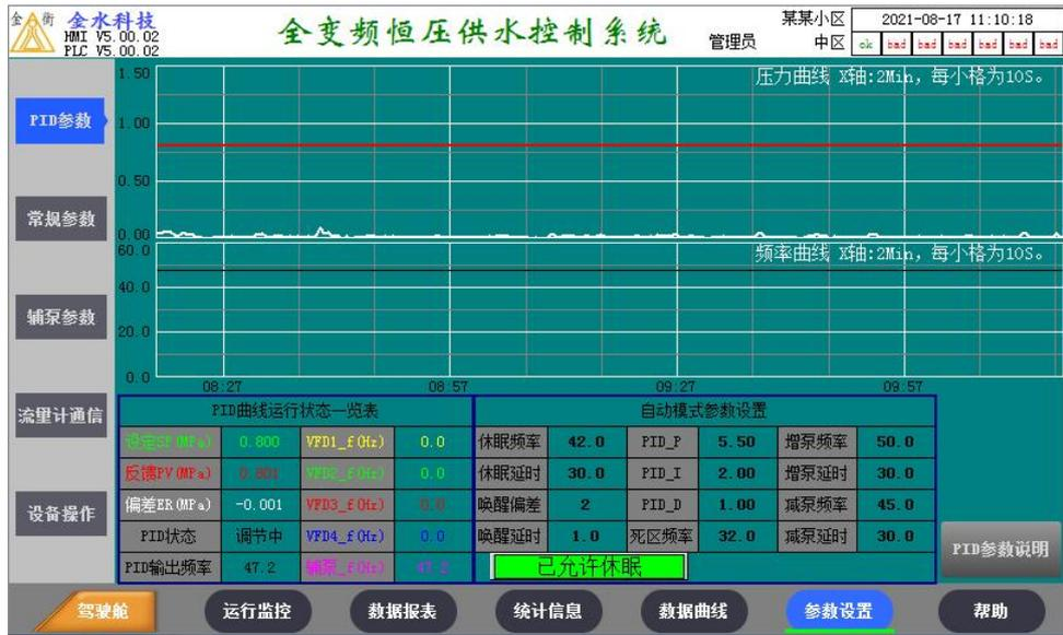
简介：该页面用于调整系统PID参数，上部为设定值、反馈值、偏差值的实时曲线，中部为频率输出实时曲线，下部为参数修改区域，该页面对水压稳定性起着决定性作用，因此非专业人员禁止修改该页面的参数。
