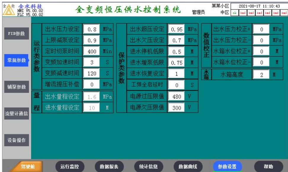
简介：该页面用于调整系统常规参数，如出水压力设定值、传感器量程、各类保护限值等，可根据用户实际需求进行修改。
